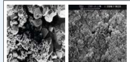
Bild 1: 2 Jahre alte Batterie, nie benutzt und stark sulfatiert. Kaum mehr brauchbar.
