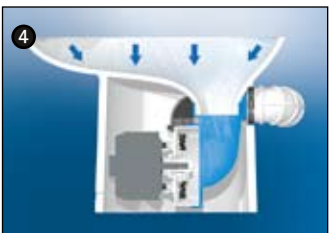
4 Das WC ist entleert. Automatisch wird Wasser für den Geruchsverschluß eingespült.
