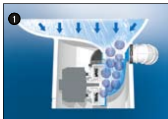
1 Start des Spül- und Absaugprogramms. Automatischer Motoranlauf.
