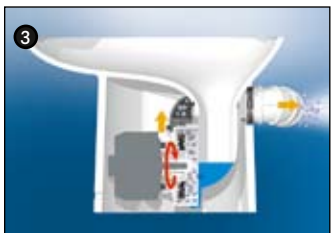
3 Abpumpvorgang. Als Abgangsleitung genügt ein Schlauch mit 25-38mm ø.
