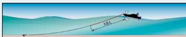
Bild 3 Bei stärkerem Seegang sollte man die Ankerkette mit einer guten Ankerleine um mindestens 1/3 verlängern.
