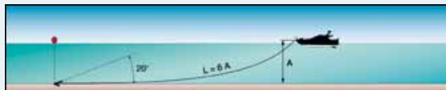
Bild 1 Der Anker kann nur gut eindringen, wenn der Winkel zwischen Schaft und Boden weniger als 20° beträgt.
