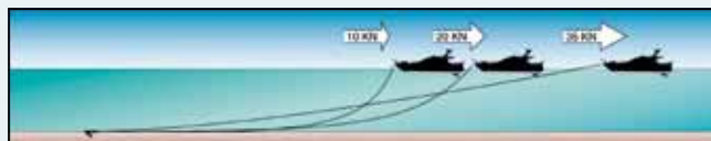
Bild 2 Wird der Wind stark, dann hebt sich der Schaft und es ist besser die Kette oder Ankerleine zu verlängern.
