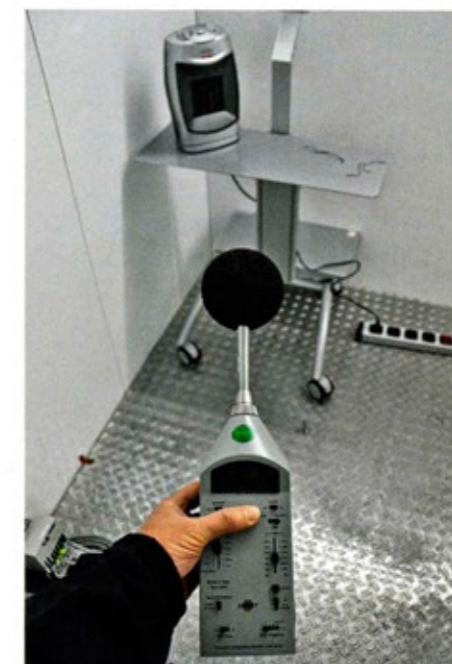
In einem definierten Abstand haben wir die Geräuschentwicklung mit einem geeichten Gerät gemessen
