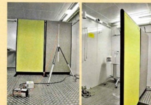
Stellwände haben den Raum unterteilt, um die Aufwärmung zu erschweren. Die Lüfter standen jenseits der Wand, die Sensoren diesseits
