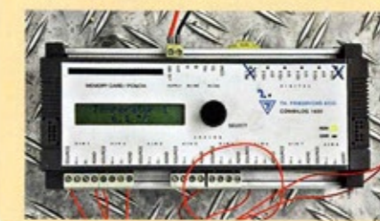
Im Sekundentakt hat ein Datenlogger die Informationen der Sensoren aufgezeichnet
