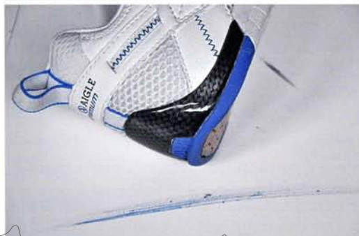
Der blaue Sohlenbereich am Schuh von Aigle macht hässliche Streifen auf dem Deck (li.), die Kappe ist fest und bietet guten Schutz, das Material ist aber mehr Schein als Sein (re.)
